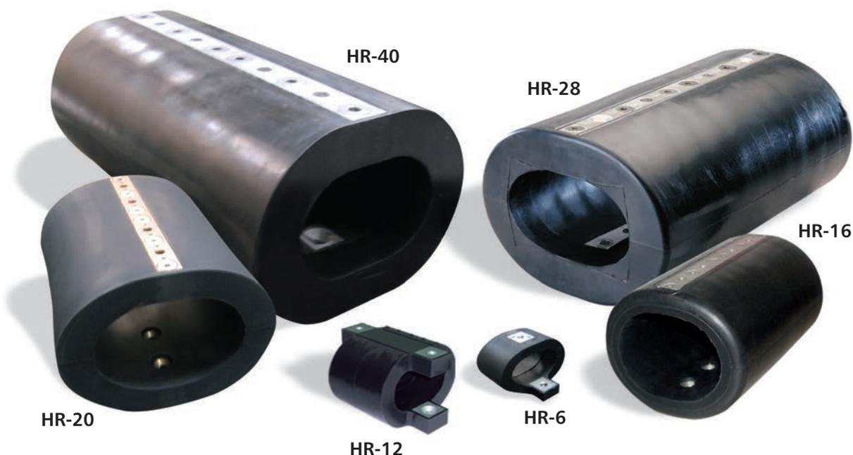
Der HERM Isolator ist eine Weiterentwicklung der traditionellen ITT Enidine Drahtseilfeder mit einer schützenden Elastomerumhüllung. Das rostfreie Kabel verbunden mit den Befestigungsleisten gewährleistet eine mechanisch robuste Konstruktion, wobei das umhüllende Elastomer eine zusätzliche Dämpfung und Steifigkeit erzeugt. Diese Konstruktion ermöglicht ein absolut betriebssicheres System mit einer höheren Steifigkeit und somit einer höheren Energieabsorptionsfähigkeit.
