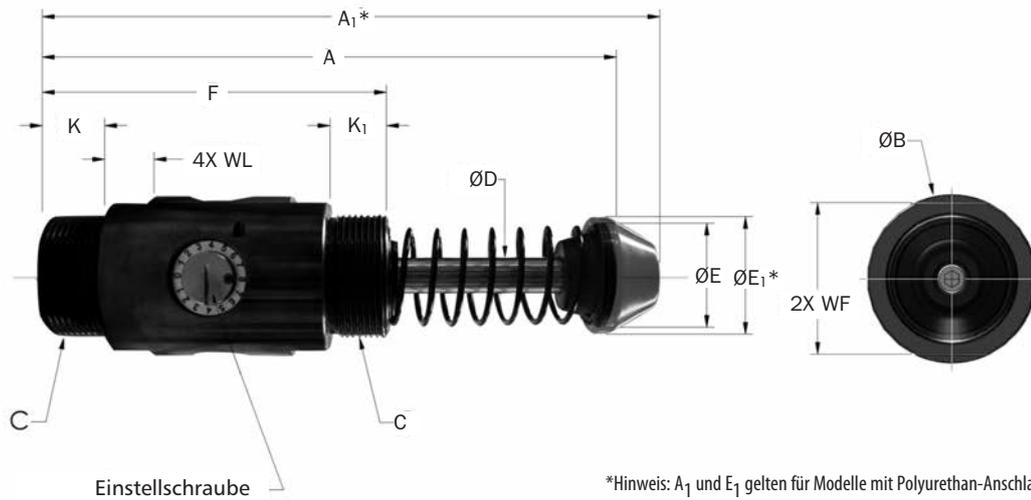
\*Hinweis: A<sub>1</sub> und E<sub>1</sub> gelten für Modelle mit Polyurethan-Anschlagkappe.
