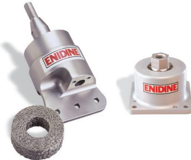
Wire Mesh Isolatoren können in einer Vielzahl von unterschiedlichsten Formen und Gestaltungsarten hergestellt werden um die spezifischen Anwendungsfälle abzudecken. Während der permanenten Bewegungen wird Reibungsenergie erzeugt. Das Drahtseilgeflecht des Wire Mesh Isolators wandelt nun diese kinetische Energie in thermische Energie um. Diese verknüpften Metallstrukturen weisen eine elastische Rückfederung auf, die eine entsprechend hohe nicht lineare Dämpfungsrate ermöglicht.
