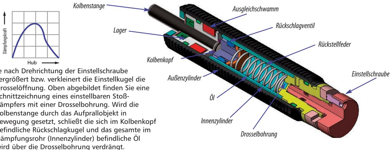
Je nach Drehrichtung der Einstellschraube vergrößert bzw. verkleinert die Einstellkugel die Drosselöffnung. Oben abgebildet finden Sie eine Schnittzeichnung eines einstellbaren Stoßdämpfers mit einer Drosselbohrung. Wird die Kolbenstange durch das Aufprallobjekt in Bewegung gesetzt, schließt die sich im Kolbenkopf befindliche Rückschlagkugel und das gesamte im Dämpfungsrohr (Innenzylinder) befindliche Öl wird über die Drosselbohrung verdrängt.
