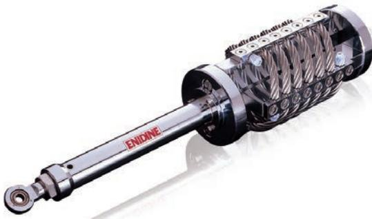
Der WEAR™ ist ein Spezialdesign der Drahtseilfeder, konstruiert zur Reduzierung und Prävention von dauerhaften statischen Vibrationen sowie zur Isolation von seismischen und dynamischen Kräften. Diese neue Generation der Energie Absorption zeigt eine einfache Konstruktion. Ohne Öl, Dichtungen oder komplexe sich bewegende Teile erfüllt sie ihre Aufgabe. Diese Konstruktion eliminiert Probleme die häufig im Zusammenhang mit hydraulischen oder mechanischen Dichtungs- und Spannelementen auftraten.
