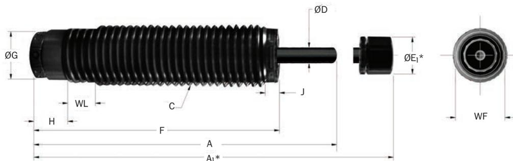
\*Hinweis: A<sub>1</sub> und E<sub>1</sub> gelten für Modelle mit Polyurethan-Anschlagkappe. Bei Lieferung eines jeden Stoßdämpfers ist eine Sechskantmutter enthalten.
