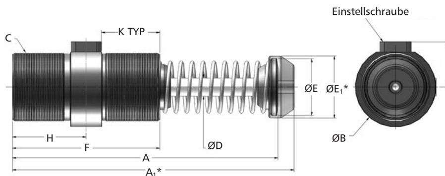
\*Hinweis: A<sub>1</sub> und E<sub>1</sub> gelten für Modelle mit Polyurethan-Anschlagkappe.
