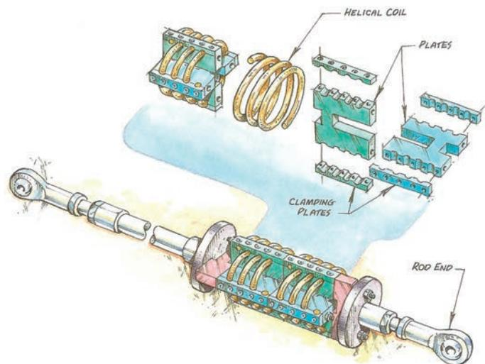
Das Drahtseil wird jeweils um 90° durch die Stege fixiert. Durch die konstruktive 2er Teilung der Aufnahmeplatte wird eine Verwindung oder Verdrehung des Drahtseils verhindert.
