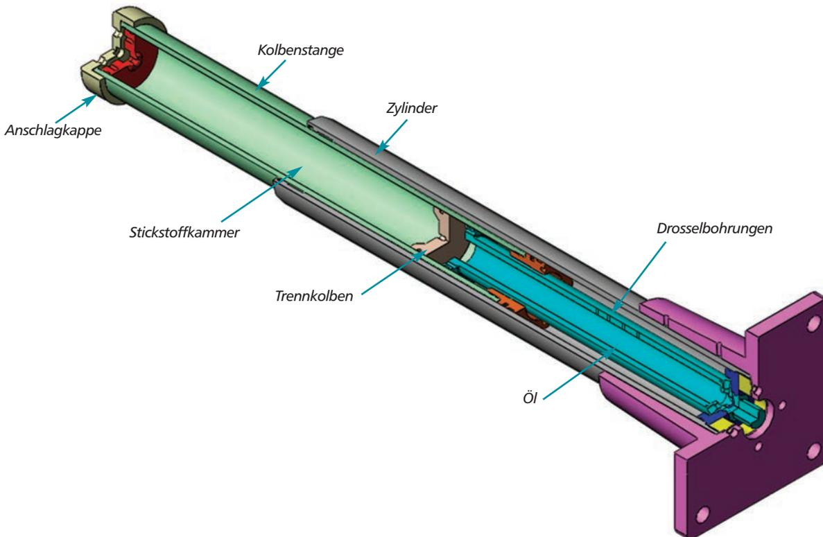
**HI Modelle** basieren auf dem System eines konzentrisch zum Außenzylinder eingebauten Innenzylinders, in den in der Längsrichtung verteilt einzelne Drosselbohrungen eingebracht sind. Während der Kolbenbewegung nach dem Aufschlag des Bewegungsobjektes wird das im Innenzylinder befindliche Öl über die Drosselbohrungen in die mittels Stickstoff vorgespannte Hohlkolbenstange verdrängt. Während der Kolbenbewegung wird durch Überfahren der Drosselbohrungen die Drosselfläche verringert.
