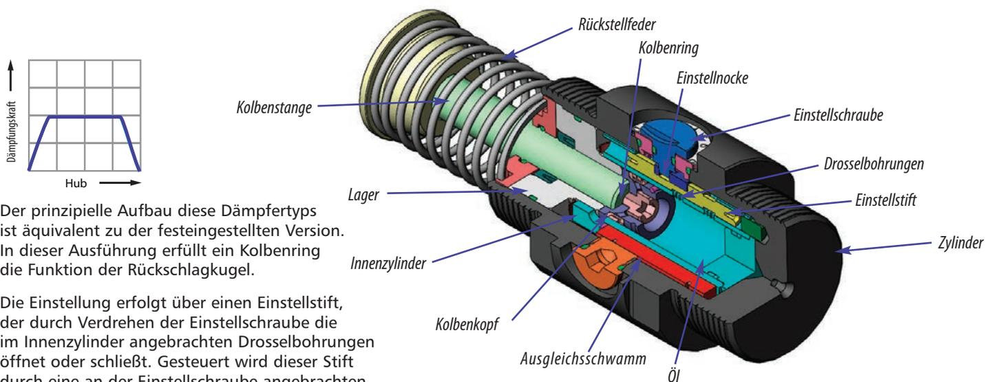
Der prinzipielle Aufbau diese Dämpfertyps ist äquivalent zu der festeingestellten Version. In dieser Ausführung erfüllt ein Kolbenring die Funktion der Rückschlagkugel.
