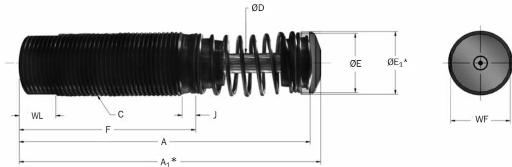
\*Hinweis: A<sub>1</sub> und E<sub>1</sub> gelten für Modelle mit Polyurethan-Anschlagkappe.
