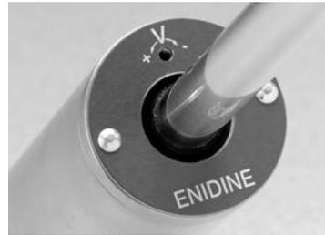
EINSTELLSCHRAUBE UM 1 3/4 ÖFFNEN UM MINIMALE DÄMPFUNGSKRAFT ZU GEWÄHRLEISTEN.
