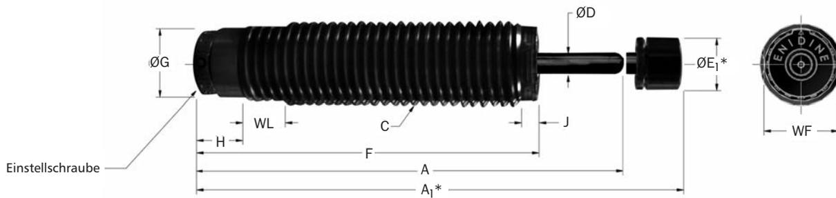
\*Hinweis: A<sub>1</sub> und E<sub>1</sub> gelten für Modelle mit Anschlagkappe.
