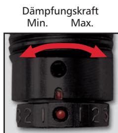
Erscheint die Dämpfung zu weich (Stoßdämpfer arbeitet ohne sichtbare Dämpfung und schlägt am Hubende an), die Einstellung auf die nächstgrößere Zahl drehen. Die Einstellungen müssen Schritt für Schritt vorgenommen werden, um interne Beschädigungen des Stoßdämpfers zu vermeiden (Beispiel: Stellen Sie von 0 auf 1, und nicht von 0 auf 4).
