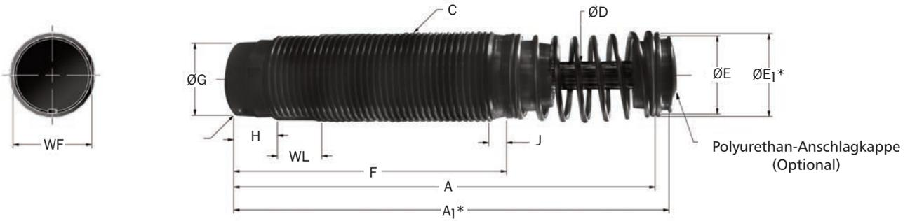
\*Hinweis: A<sub>1</sub> und E<sub>1</sub> gelten für Modelle mit Polyurethan-Anschlagkappe.
