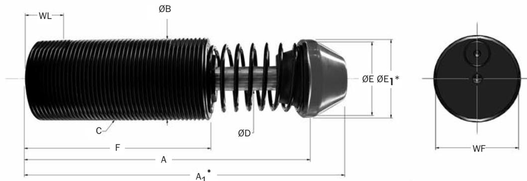
\*Hinweis: A<sub>1</sub> und E<sub>1</sub> gelten für Modelle mit Polyurethan-Anschlagkappe.
